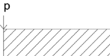
Gambar 2.12 Beban Terpusat di Ujung Balok Kantilever
