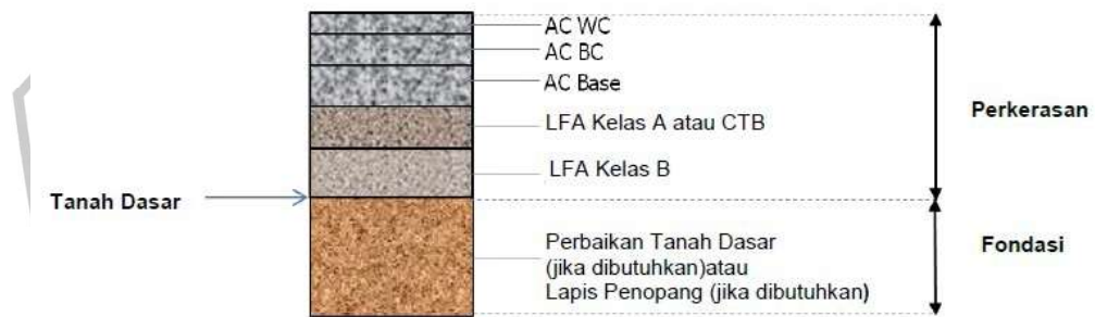
Gambar 2.1 Perkerasan Lentur pada Permukaan Tanah Asli (MDP, 2017)
