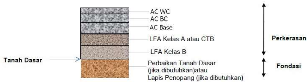
Gambar 2.3 Perkerasan Lentur pada Galian (MDP, 2017)
