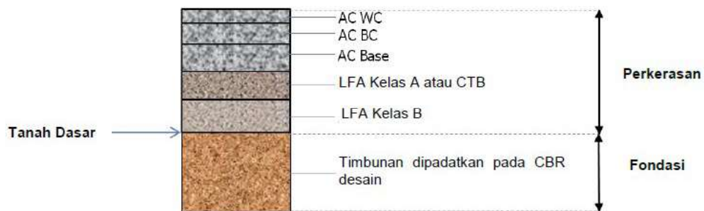
Gambar 2.2 Perkerasan Lentur pada Timbunan (MDP, 2017)
