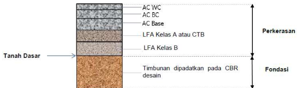
Gambar 2.2 Perkerasan lentur pada timbunan (MDP, 2017)
