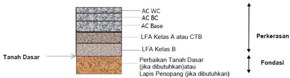
Gambar 2.3 Perkerasan Lentur Pada Galian (MDP, 2017)
