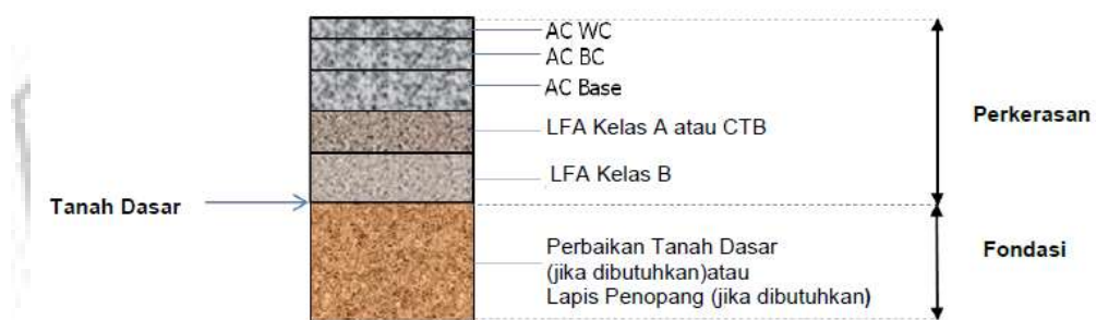
Gambar 2.1 Perkerasan lentur pada permukaan tanah asli (MDP, 2017)
