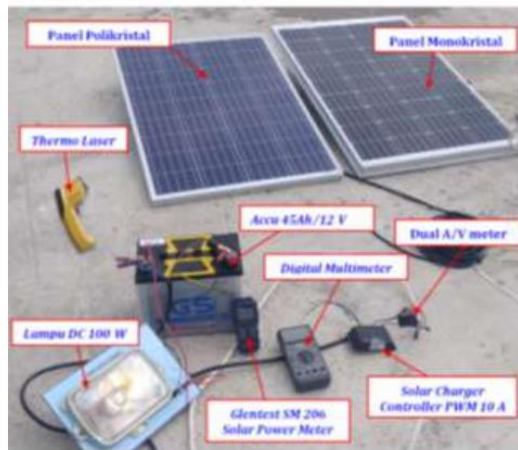
Gambar 2.4 Instalasi peralatan pengujian panel surya
