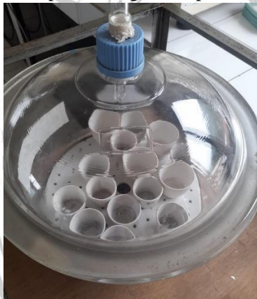
Desikator yang digunakan untuk pendinginan
