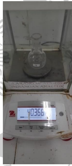
Timbangan analitik yang digunakan untuk menimbang labu lemak
