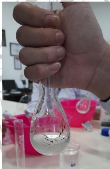
Penambahan aquades sebelum melakukan destilasi
