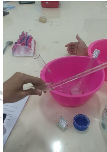
Penambahan NaOH sebelum melakukan destilasi
