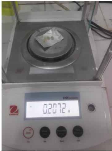
Timbangan analitik yang digunakan untuk penimbangan sampel
