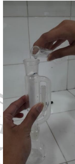
Penuangan larutan benzene ke dalam labu
