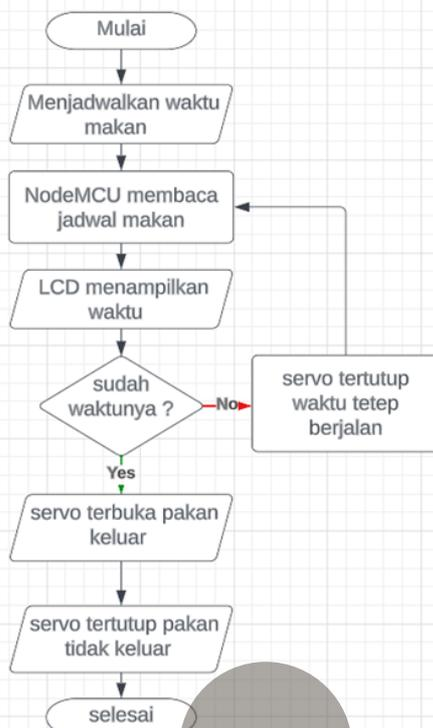
Gambar 1. Flowchart Rangkaian Sistem Keseluruhan
