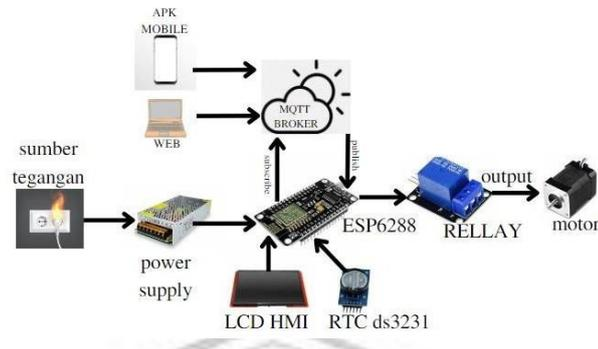
**Gambar 3. 4** Desain Sistem Keseluruhan
