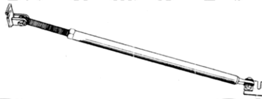
Gambar 2. 4 Stempel sekrup yang dapat disetel (F. Wighout, 1992 hal 86)
