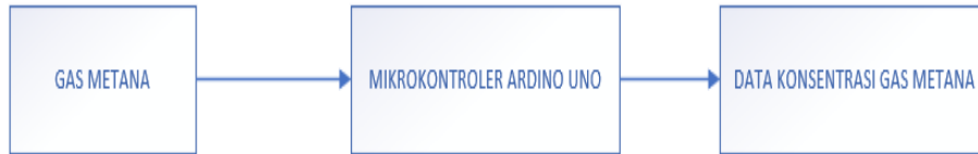
Gambar 3. 2 Diagram Blok Pengukuran Konsentrasi Gas Metana
