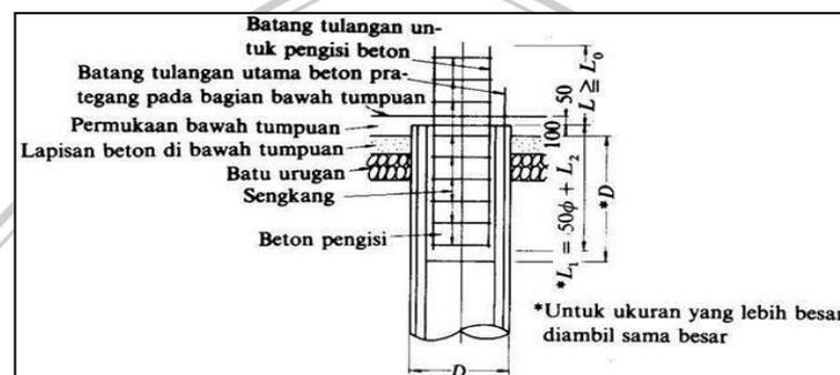
**Gambar 2. 8** Sambungan tiang pancang dengan pile cap
