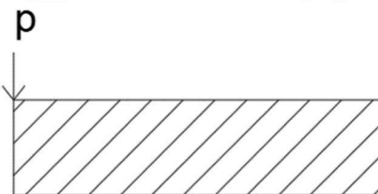
Gambar 2. 19 Beban Terpusat di Ujung Balok Kantilever
