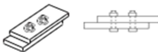
Gambar 2. 18 Sambungan Baut Pada Baja
