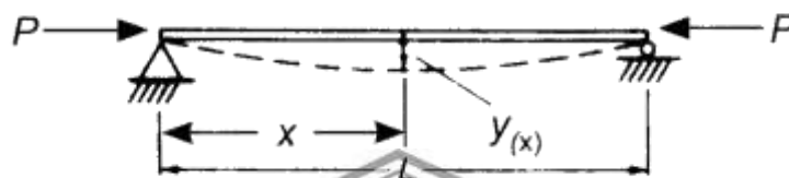
Gambar 2. 14 Batang Tekan Mengalami Tekuk (Sumber: Setiawan, 2008)
