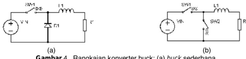
Gambar 4. Rangkaian konverter buck: (a) buck sederhana
