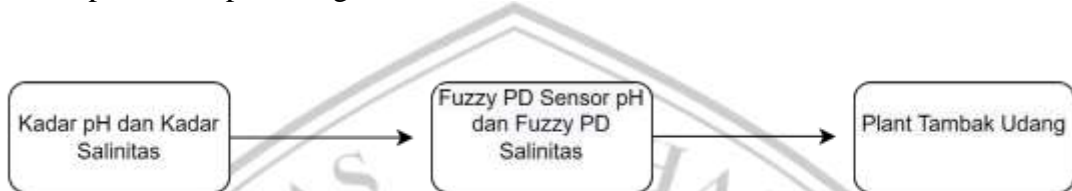
Gambar 3. 1 Perancangan Keseluruhan Sistem Kontrol Salinitas dan pH Tambak Udang Vanamei
