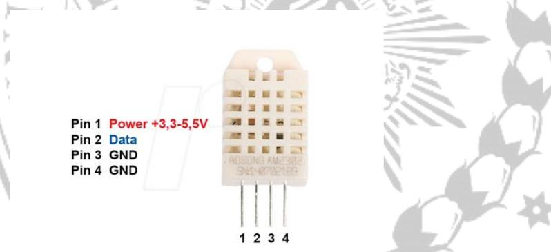
Gambar 2.2 Pinout DHT 22
