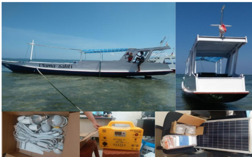
Gambar 2. TTG berupa perahu/kapal terintegrasi solar cell
