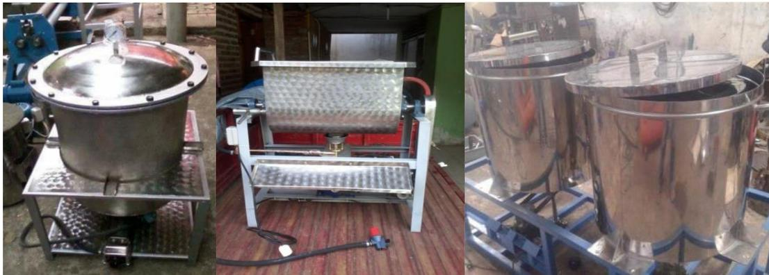
Gambar 1. TTG paket mesin pembuat abon
