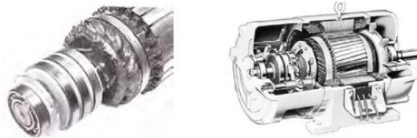
a) Tampilan Close-Up Bagian Slip Ring Rotor Belitan b) Motor Induksi Tiga Fasa Rotor Belitan
