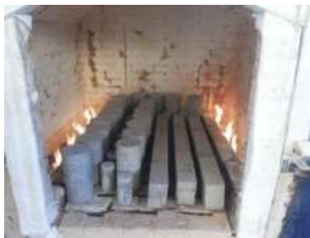
Gambar 5. Proses pembakaran benda uji silinder dan balok. (Sumber: Hasil Penelitian)
