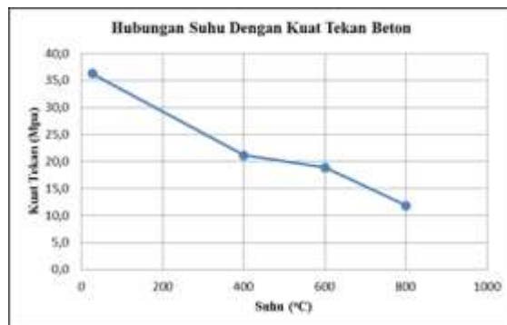
Gambar 6. Kurva hubungan kuat tekan beton dengan suhu. (Sumber: Hasil Penelitian)
