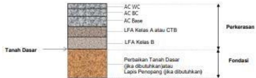
Gambar 2. 2 Perkerasan Lentur pada Permukaan Tanah Asli
