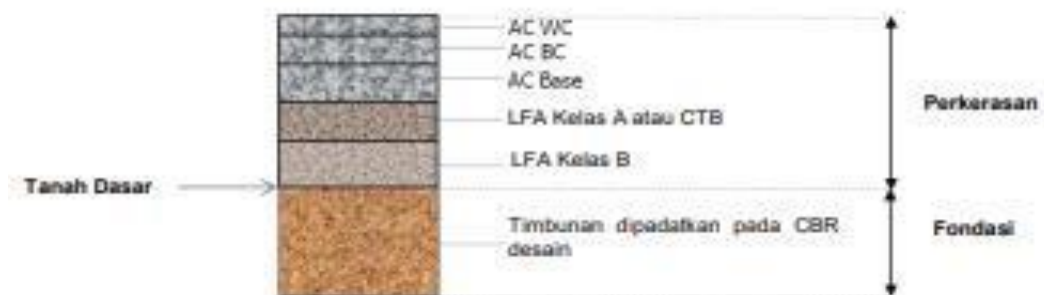
Gambar 2. 3 Perkerasan Lentur pada Permukaan Tanah Asli
