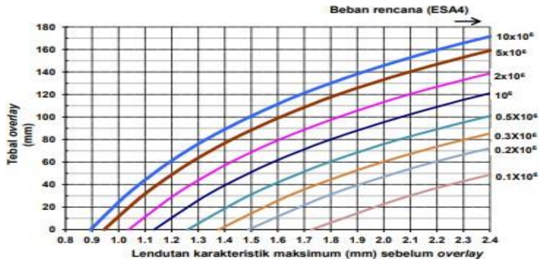
Gambar 2. 4 Solusi Overlay Berdasarkan Lendutan Balik Benkelman Beem untuk WMAPT 41°C Sumber: MDP, 2017 : 6-4
