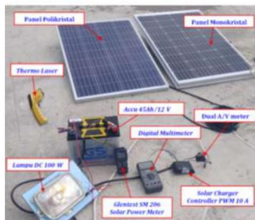
Gambar 2.3 Skema Perancangan Alat Penelitian
