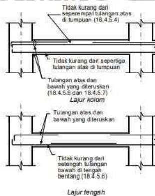
Gambar 2. 29 Penempatan Tulangan pada Pelat
