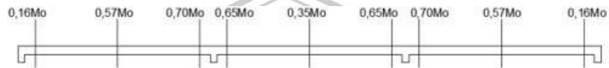
Gambar 2. 11 Koefesien Moemn Pelat Dua Arah dengan Balok di Antara Semua Tumpuan (Lajur Kolom)
