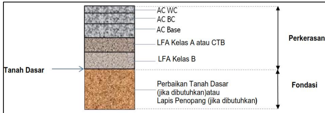
Gambar 2.2 Struktur Perkerasan Lentur pada Tanah Dasar (Direktorat Jenderal Bina Marga, 2017:1-3)
