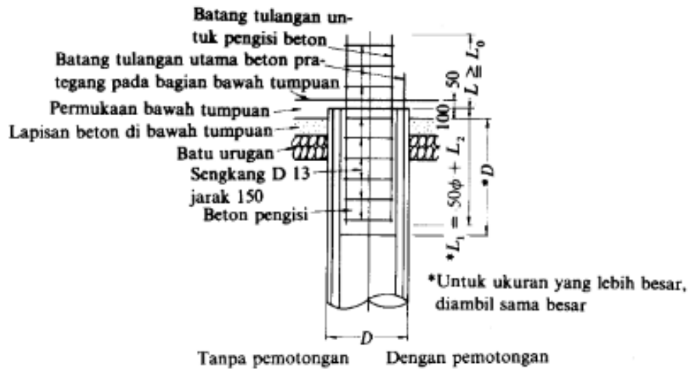
Gambar 2.10 Sambungan tiang pancang dengan pile
