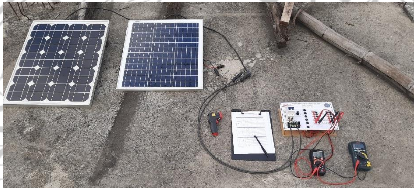
Gambar 2.3 Instalasi Peralatan Pengujian Panel Surya
