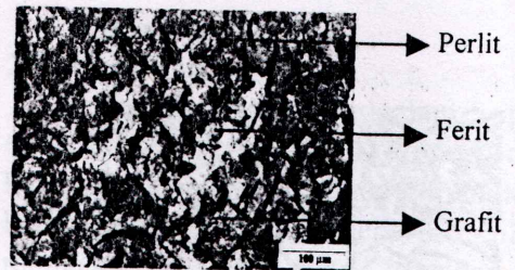
Gambar 3. Perlit (Bagian yang Gelap) dan Ferit (Bagian yang Terang), Etsa : Nital 2% Sumber : Bhadeshia, 2000
