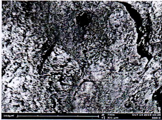
a. Stress relief annealing 500 0 C,
