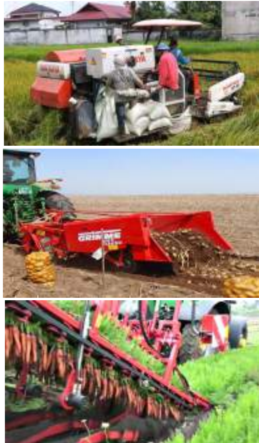
Gambar 20. Alat panen berbasis mesin, a). padi; b) kentang; dan c) wortel
