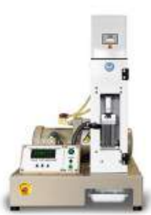
Gambar 17. Tenderometer untuk menguji kematangan kacang polong dengan alat presser tester
