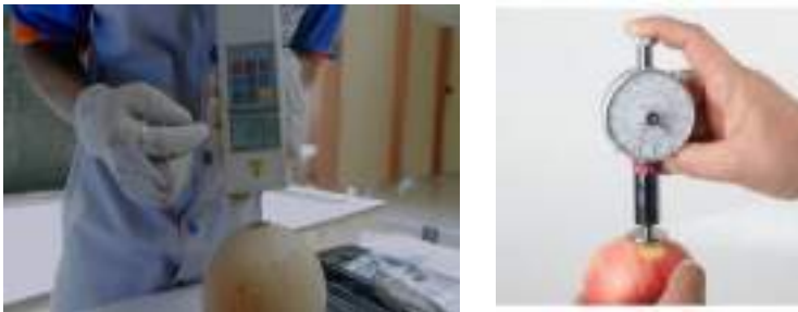
Gambar 16. Alat pnetrometer untuk menguji kekerasan buah
