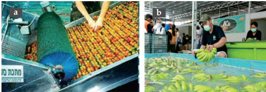
Gambar 24. Kegiatan pembersihan a) dengan mesin yang dilengkapi dengan sikat, dan b) dengan air yang diberi chlorin
