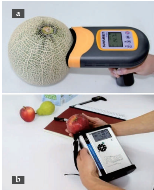
Gambar 18. Alat pencitraan berbasis NIR spectrometer untuk mengukur kematangan atau kadar gula buah. (Sumber foto : a. koreaportal.com dan b. felixinstruments.com)
