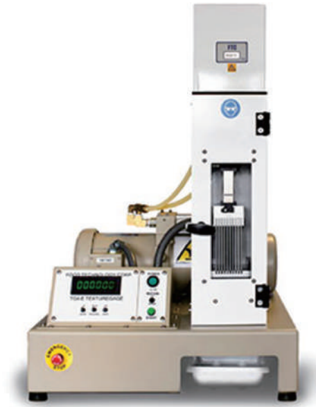
Gambar 17. Tenderometer untuk menguji kematangan kacang polong dengan alat presser tester
