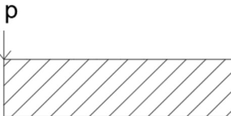
Gambar 2. 16 Beban Terpusat di Ujung Balok Kantilever
