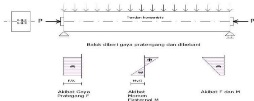
Gambar 2. 15 Distribusi Tegangan Sepanjang Penampang Beton Prategang Konsentris
