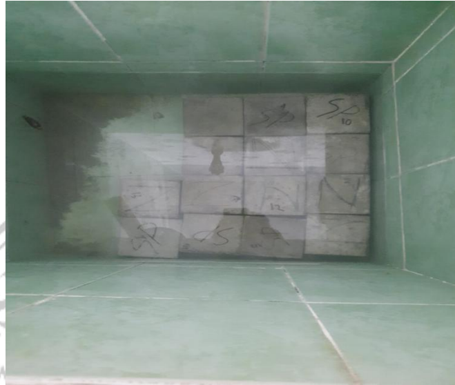
Gambar 4.3 Curing Benda Uji Kubus
