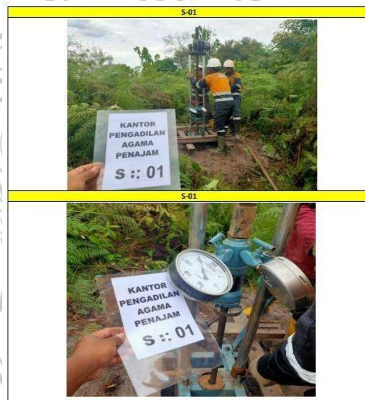
**Gambar 3. 4** Titik uji pengujian tanah sondir
