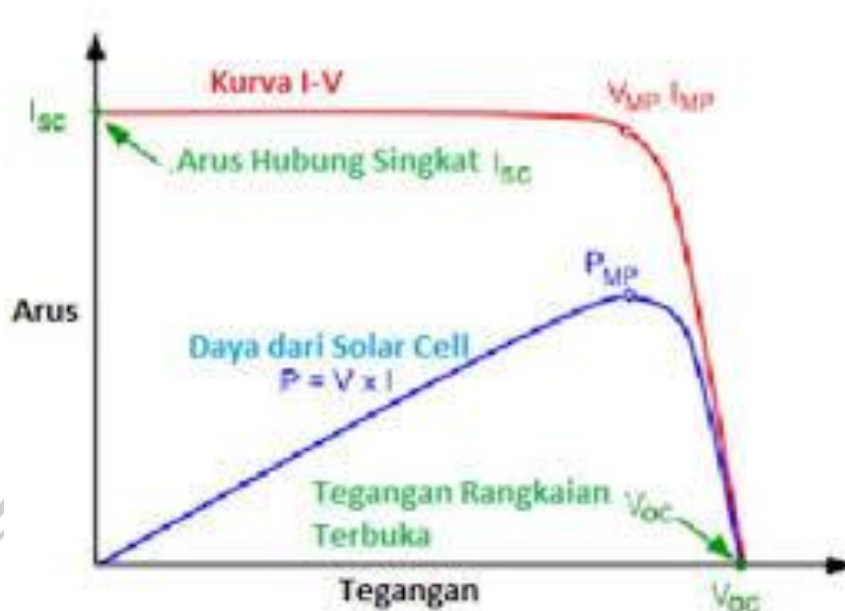
Gambar 2.5 Kurva IV dan PV pada Sebuah Modul
