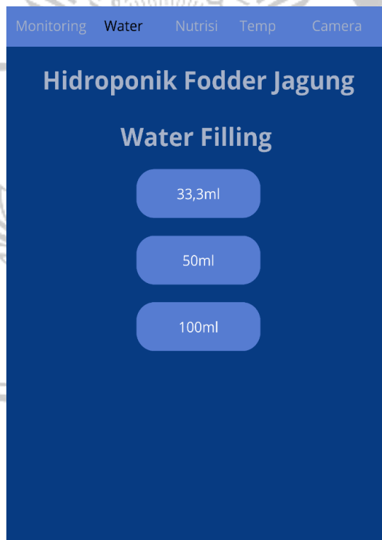
Gambar 3.6 Desain Web Kontrol Penyiraman air Fodder Jagung
