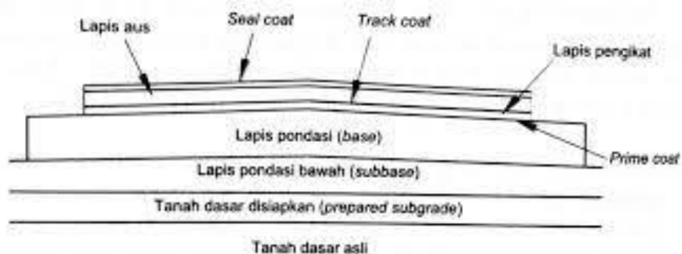
Gambar 2. 2 Komponen Struktur Perkerasan Lentur
