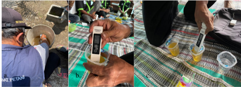
Gambar 4. Pemantauan Hasil Fermentasi Urine Sapi Untuk POC, Ket a. Pengukuran TDS Pada Hasil Fermentasi 7 Hari, b. hasil pengukuran TDS, c. Hasil perbandingan fermentasi 7 hari dan 30 hari menggunakan dekomposer pembanding.
