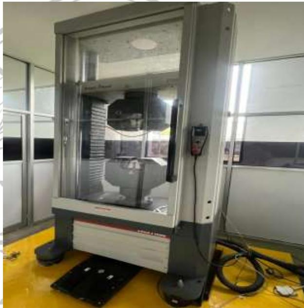
**Gambar 3.16** Mesin Uji Tarik Zwick Roell
