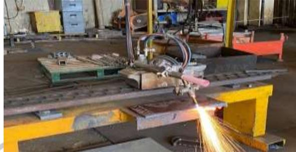
**Gambar 3.5** Pembuatan Sudut  $30^\circ$
