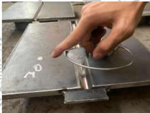
**Gambar 3.6** Pengukuran Root Gap menggunakan Welding Gauge
