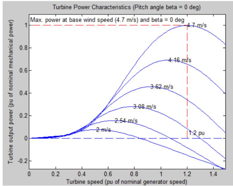
Gambar 2. Karakteristik Daya Mekanis Turbin Angin
