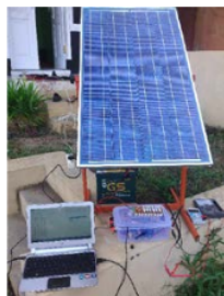
Gbr. 11 Pengujian sistem MPPT.
