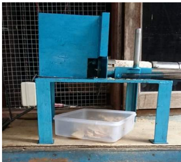
Gambar 5. Mesin Pengiris Tempe Multi Fungsi
