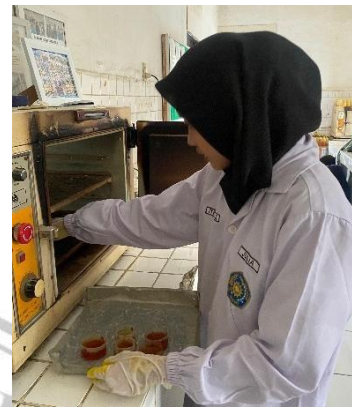
Gambar 6. Pengujian Kadar Air
