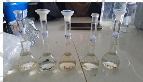
Mengencerkan menjadi beberapa konsentrasi 0 ppm, 20 ppm, 40 ppm, 60 ppm, 80 ppm, 100 ppm.
