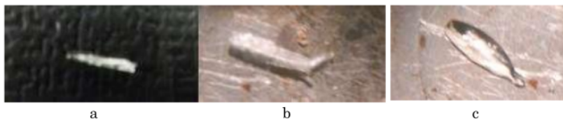
Gambar 6. Hasil Penentuan Titik Lebur Isolat (a) penampakan fisik kristal isolat, (b) sebelum melebur dan (c) setelah melebur
