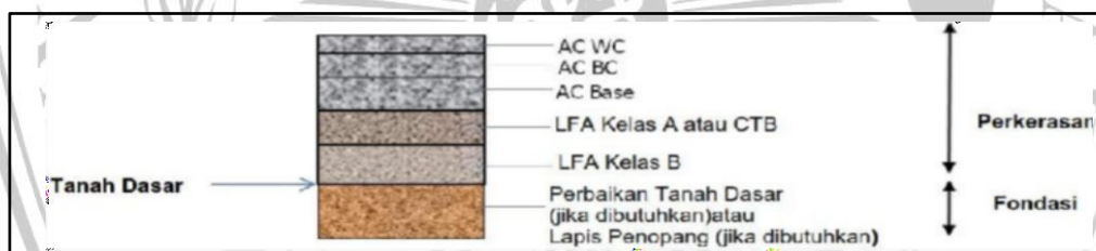
Gambar 2. 11 Struktur Perkerasan Lentur pada Tanah Timbunan
