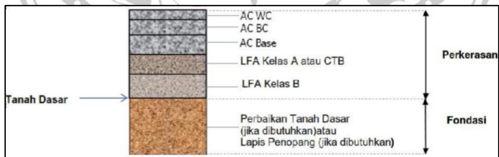
Gambar 2. 12 Struktur Perkerasan Lentur pada Tanah Galian
