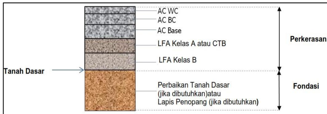
**Gambar 2.2** Struktur Perkerasan Lentur Pada Tanah Dasar (Kementerian Pekerjaan Umum, 2017: 1-3)
