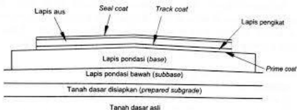
Gambar 2. 2 Komponen Struktur Perkerasan Lentur
