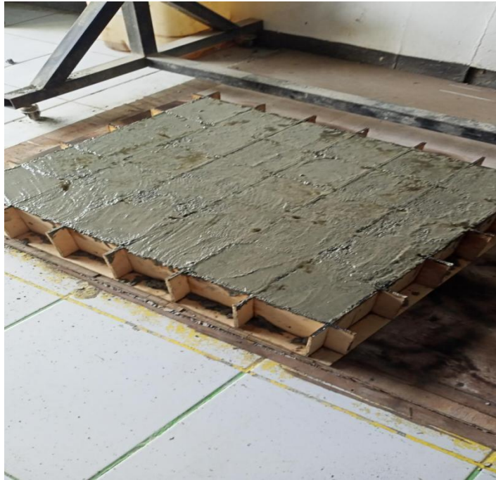
Gambar L.3 Hasil pengisian campuran ke dalam bekisting kubus
