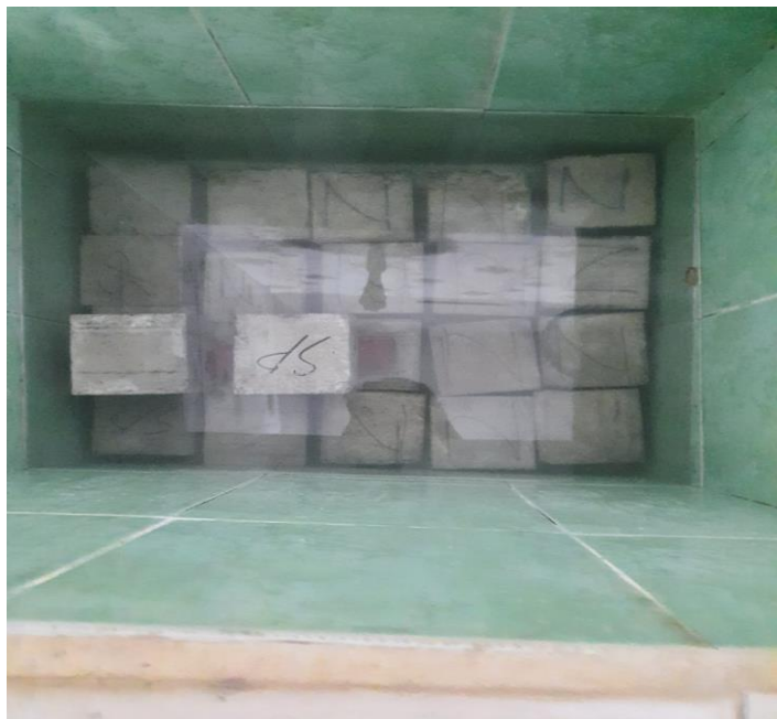
Gambar L.4 Gambar perendaman dalam bak kotak
