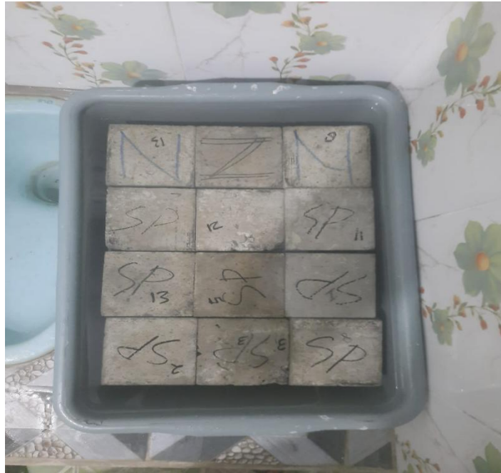
Gambar L.5 Gambar perendaman dalam bak kotak plastik
