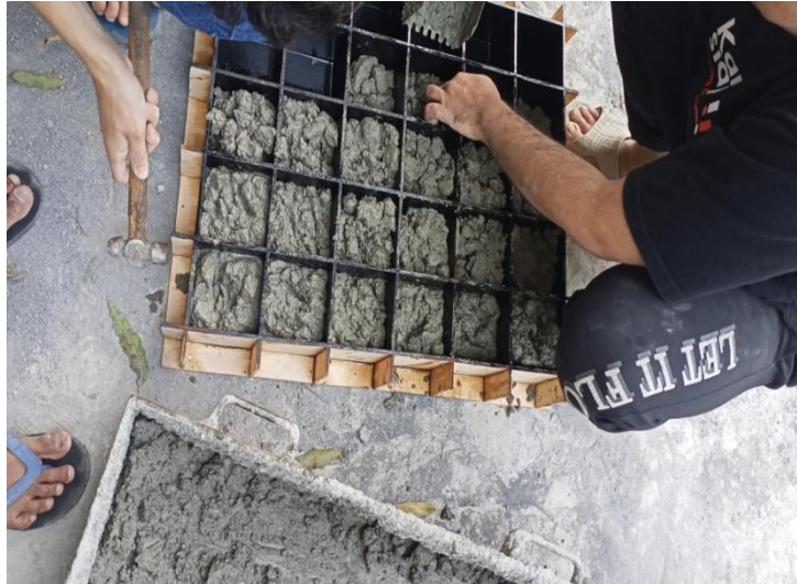
Gambar L.1 Proses mengisi campuran ke dalam bekisting kubus
