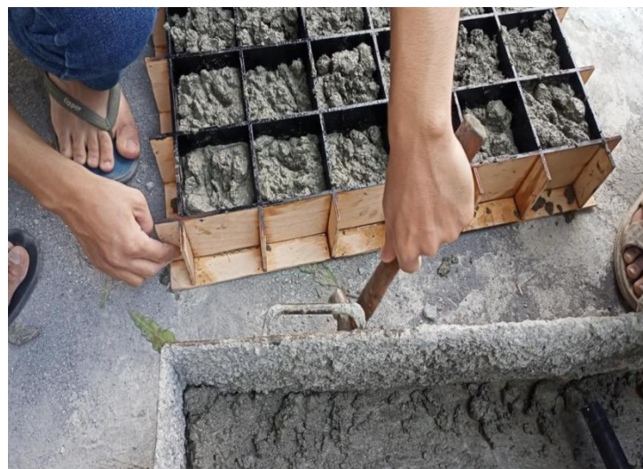
Gambar L.2 Proses meratakan bagian dalam campuran beton
