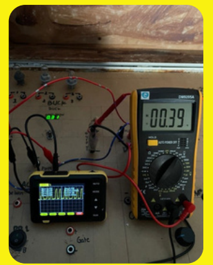
Gambar 3. Pengujian Tegangan Buck Converter tanpa beban 100
