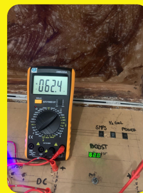
Gambar 4. Tegangan keluaran pada sudut penyalan 100
